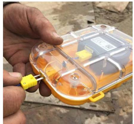
Das Sensor-Kabel wird direkt an der Bewehrung angebracht und mit dem Funksender verbunden.
