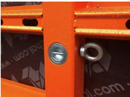
Im Elementrahmen bündig eingebaute Verspanneinheit
