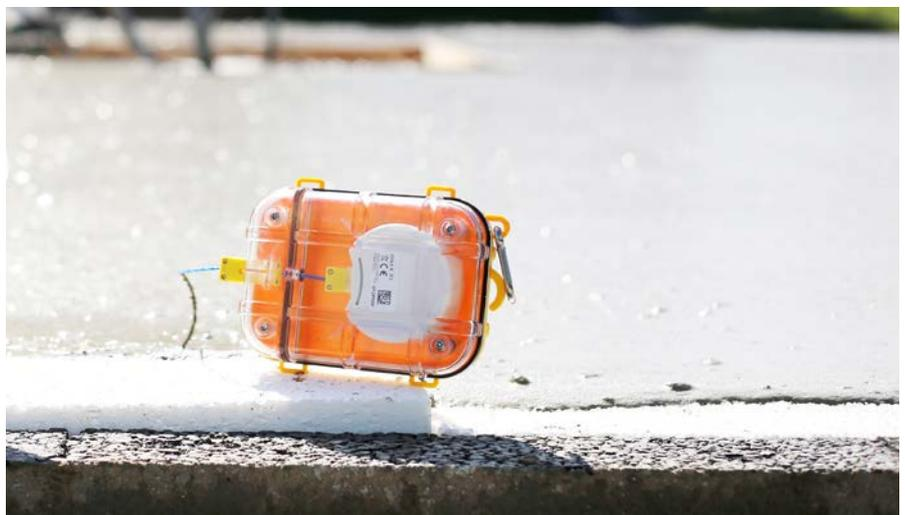
Sensor sendet die Messdaten kabellos über das Sigfox Netzwerk.
