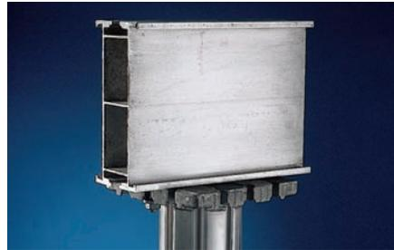
Beim GASS Aluminium-Traggerüst-System ist das Joch ein 22,5 cm hoher Aluminiumträger. Dessen statische Werte (zulässige Querkraft, zulässiges Biegemoment, Trägheitsmoment) sind auf das Gesamtsystem abgestimmt. Für die verschiedensten Anforderungen auf der Baustelle gibt es Träger mit Längen von 1,80 m bis 7,20 m.
