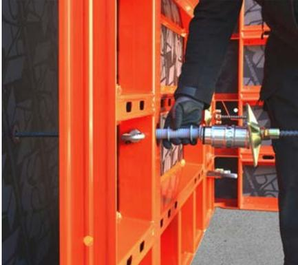
Beim einseitigen Anker wird der Spannstab zusammen mit dem Hüllrohr, der Wechselhülse und der Kugelgelenkplatte in die Verspanneinheit in der Stellschalung eingedreht.
