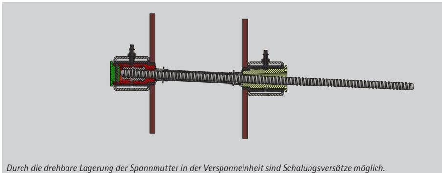
Durch die drehbare Lagerung der Spannmutter in der Verspanneinheit sind Schalungsversätze möglich.
