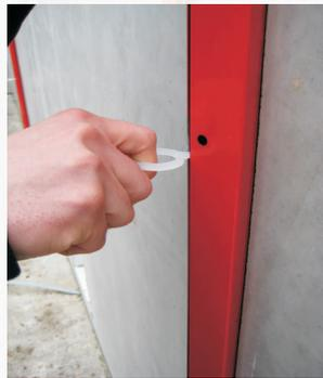
4 Die Demontage erfolgt durch Überdrehen des FLUXX-Ankers
